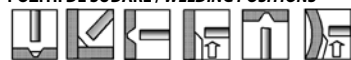
1G PA 2F PB 2G PC 3G PF 4G PE 5G PF AWS EN
