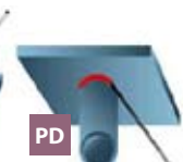
PD Teava: fixa Axa: verticala Sudura: plafon (peste cap)
