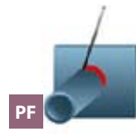
PF Teava: fixa Axa: orizontala Sudura: vertical ascendent
