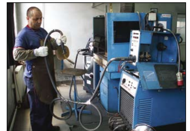
Foto 2 : sudare manuală, role lise, 4 m liner, 3 curbe în 2 plane diferite, 3 minute sudare continuă
